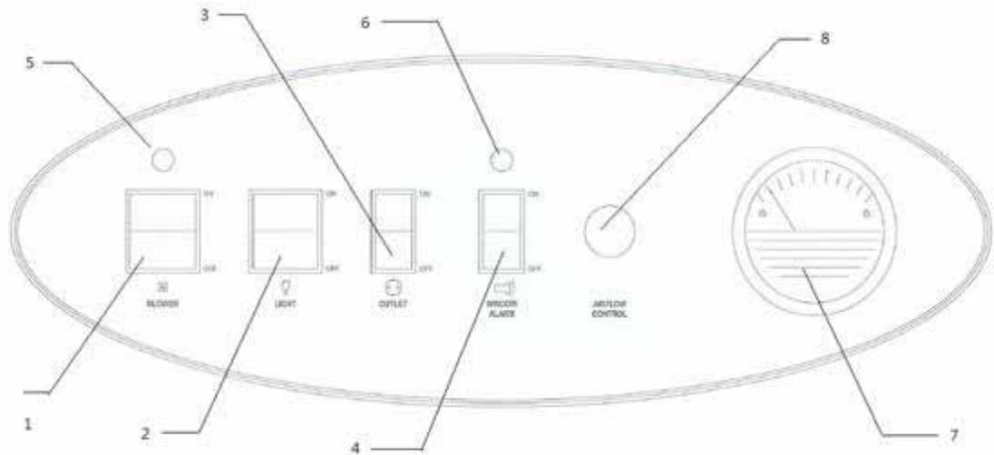
提供荧光灯或紫外线（UV）灯（选配）交换开/关控制。荧光灯和紫外线光不能同时通电。紫外线灯只会在滑动窗口被关闭时才能照射工作。
