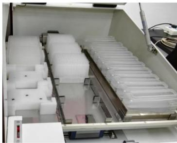
试剂/移液头/深孔板套件
