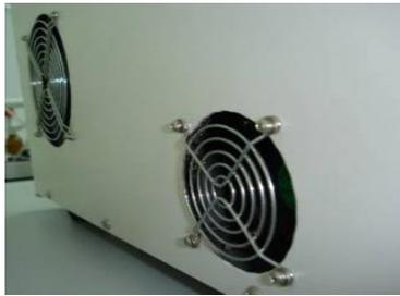
强效的不含 CFC 的压缩机使离心腔体快速冷却，并在离心的过程中保持转头在设定温度。同时，两个冷却风扇，分别是压缩机和电机冷却，迅速驱散热量以提高冷却效率和延长电机寿命。
