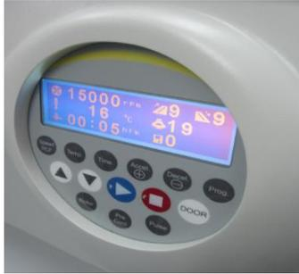
LCD 液晶显示屏显示所有实验参数，包括出现问题时故障诊断信息。此外，离心开始后，会有离心状态的实时图形显示。
